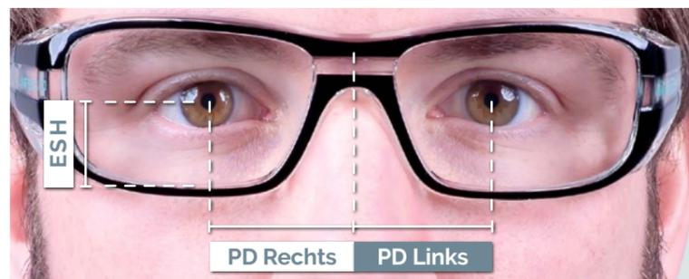
Die Brille wird dann so gefertigt, dass sich die optische Mitte der Brillengläser genau vor der Mitte der Pupillen befindet. Diese Messung ist besonders wichtig, da eine Abweichung der gemessenen PD zu Kopfschmerzen oder Übelkeit führen kann.
